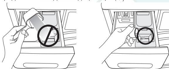
4. При использовании цикла предварительной стирки рекомендуемое количество средства для стирки следует добавить в отсек (I), для предварительной стирки.
