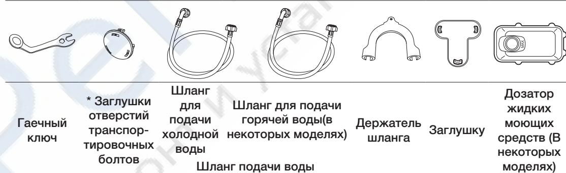
\* **Заглушки отверстий транспортировочных болтов:** Количество заглушек для отверстий под болты зависит от модели (3~5 заглушки).
