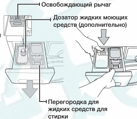
3. Промойте все части отсека проточной водой.
